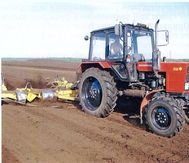
Фрезерування торфового покладу фрезером МТФ-13М.
