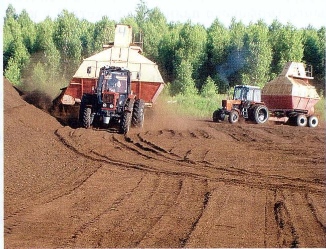
Вивантаження фрезерного торфу з торфозбиральних машин МТФ-44.
