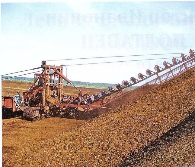
Формування штабелю фрезерного торфу штабелювальною машиною МТФ-71М.
